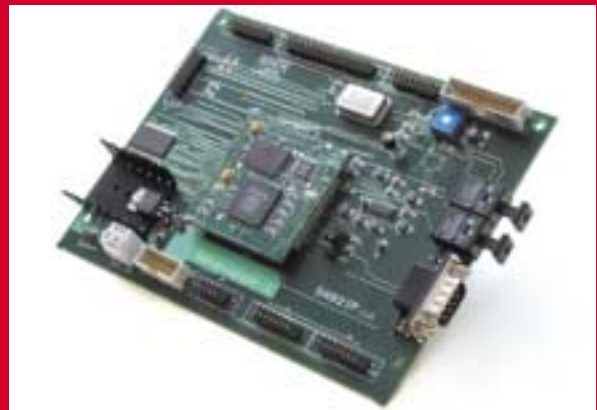
Figura 8. Fotografía de la tarjeta DAB2IP desarrollada en el proyecto ESTER.
