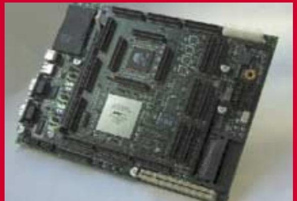
Figura 3. Plataforma basada en FPGA y procesador ARM sobre la que se prototipó el ASIC MACTSP.
