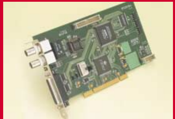
Figura 7. Fotografía de la tarjeta IP2DVB+ desarrollada en DIDACT+.
